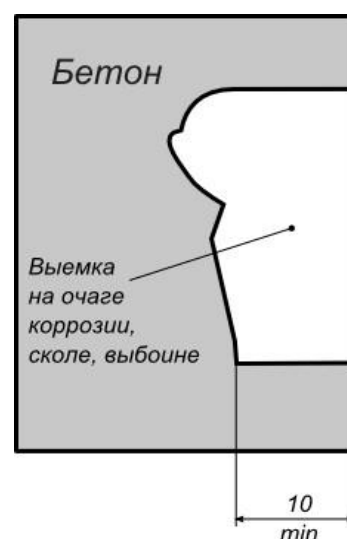
Рис. 11. Типовая схема подготовки кромок паза
